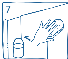
Entfernen Sie den überschüssigen Kleber mit einem feuchten Schwamm.
